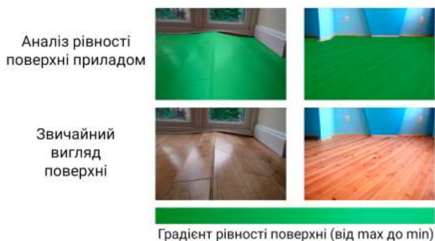
Рис. 2.1. Приклад результату аналізу рівності поверхні (підлоги) приладом та градієнт, за яким вимірюється якість
