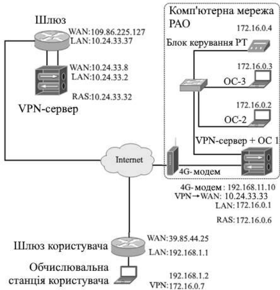
Рисунок 5.2 – Організація оверлейної мережевої архітектури в разі єдиної реальної IP -адреси
