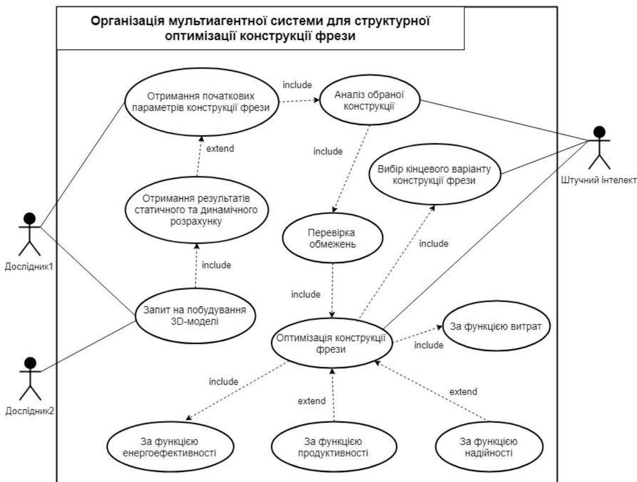
Рисунок 3.3 – Діаграма прецедентів бізнес-процесу «Структурна оптимізація конструкції фрези»
